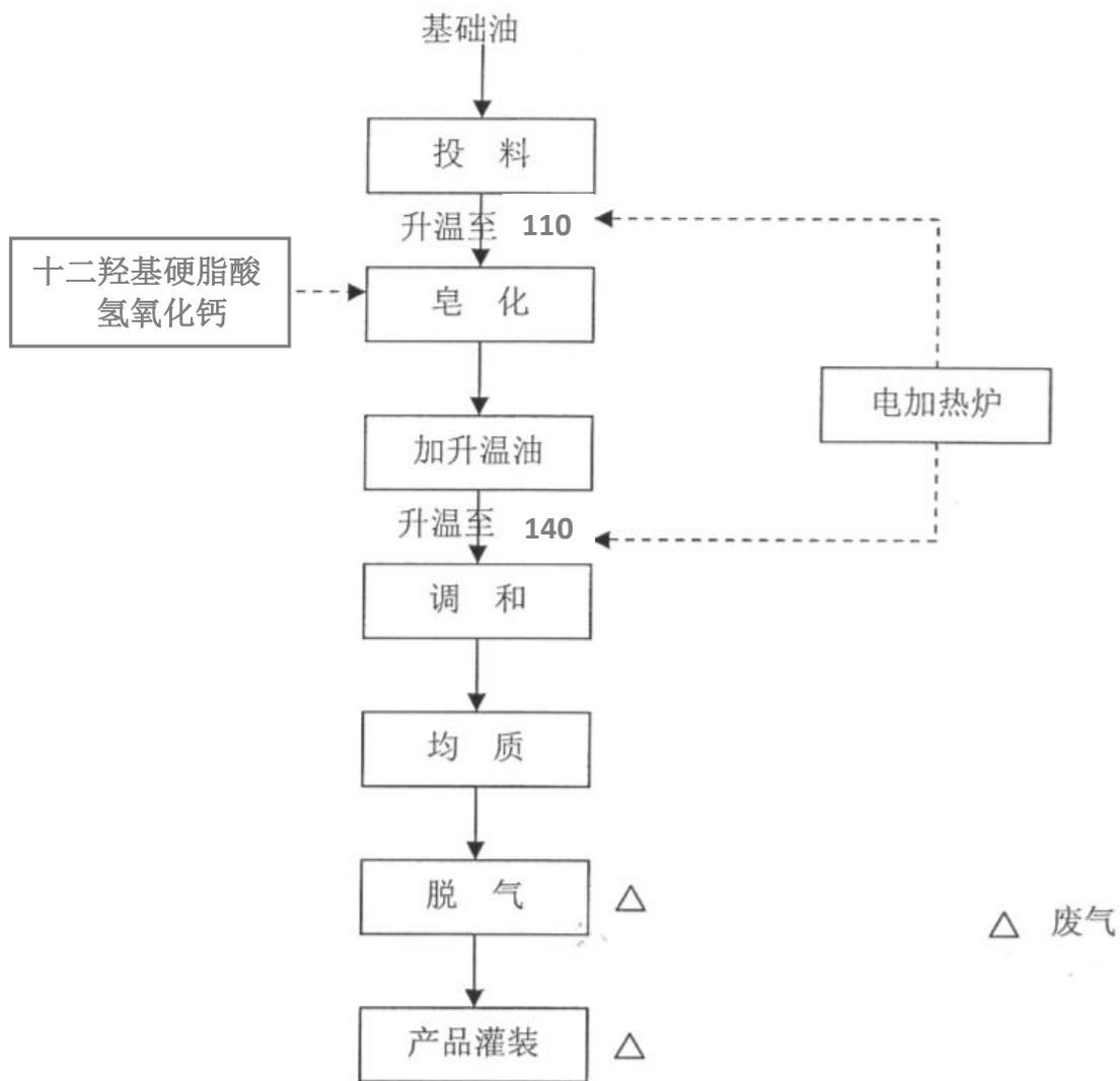
图 3-6 项目工艺流程及产物环节图
