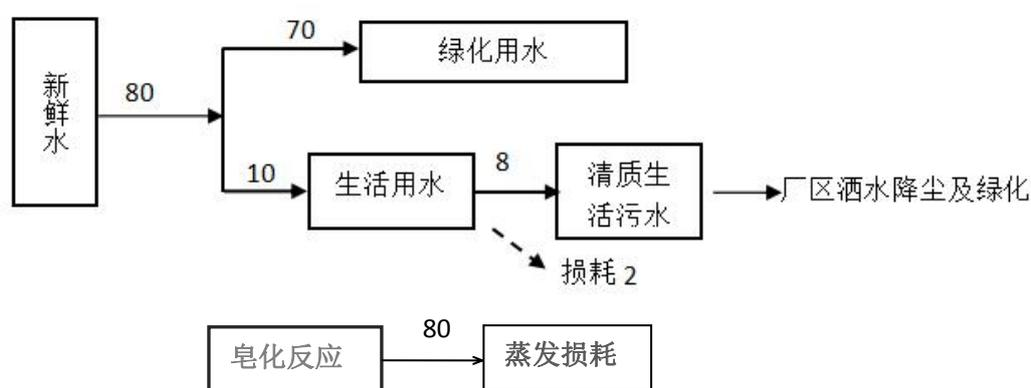
图3-5 项目水平衡图 (m<sup>3</sup>/a)
