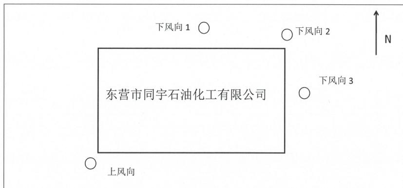
图1 厂界无组织废气采样布点图
